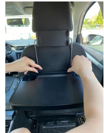
CZ - 4. Povolte dvě nastavovací kolečka na přední straně stolku, abyste upravili jeho výšku a úhel naklopení.
